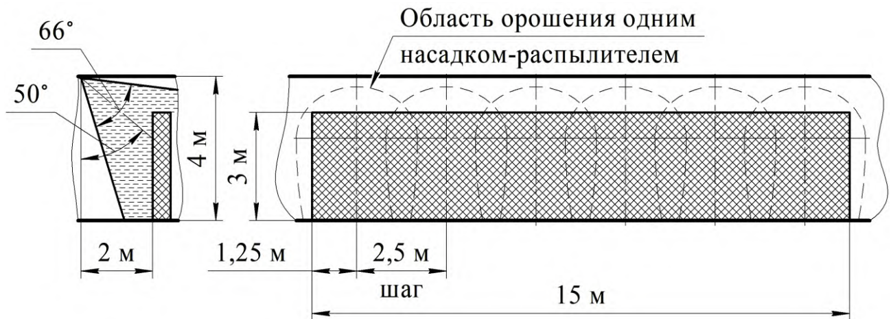
Рисунок 16 – Противопожарная защита боковой поверхности стеллажа 6-ю насадками-распылителями
