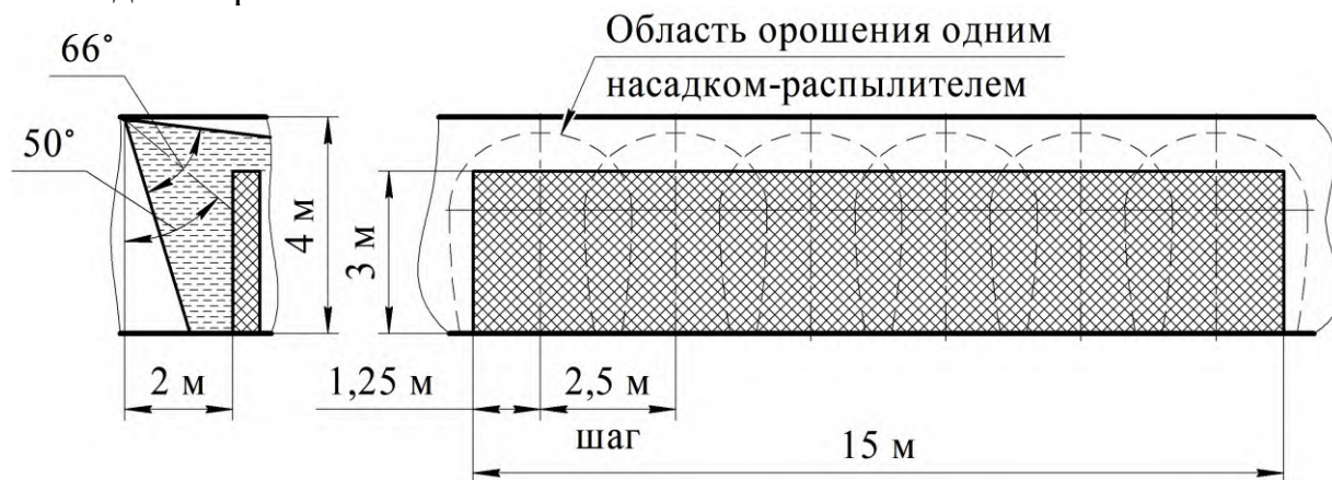
Рисунок 16 – Противопожарная защита боковой поверхности стеллажа 6-ю насадками-распылителями
