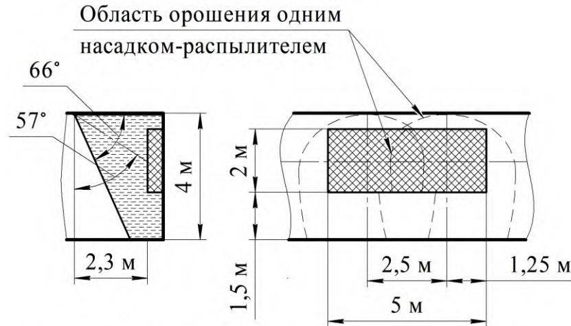
Рисунок 10. Противопожарная защита навесного шкафа 2-мя насадками-распылителями
