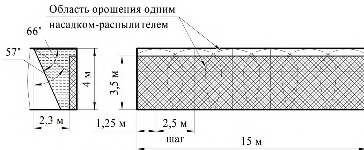
Рисунок 9. Противопожарная защита стеллажа 6-ю насадками-распылителями
