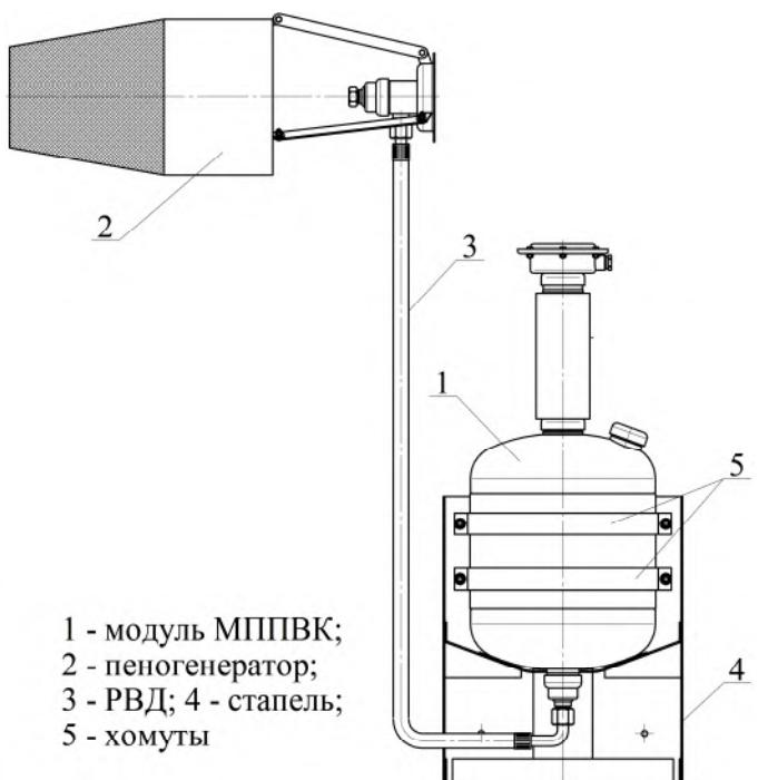
Рисунок 10 - МППВК(Взр)-28-ГЗ с горизонтальным расположением эжектора
