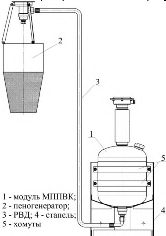
Рисунок 9 - МППВК(Взр)-28-ГЗ с вертикальным расположением эжектора
