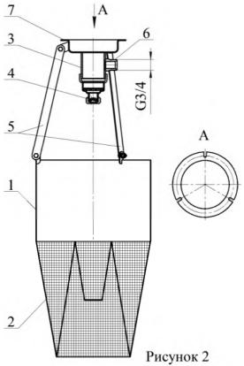
В боковой части контейнера **3** закреплен штуцер **6** для соединения через РВД с модулем (рисунок 1). В верхней части контейнер **3** снабжен кронштейном **7**, предназначенным для крепления пеногенератора к потолку, стене или иной несущей поверхности.
