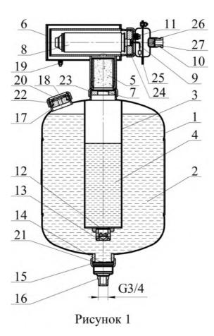
4.2 Устройство пеногенератора МППВК-28-ГЗ
