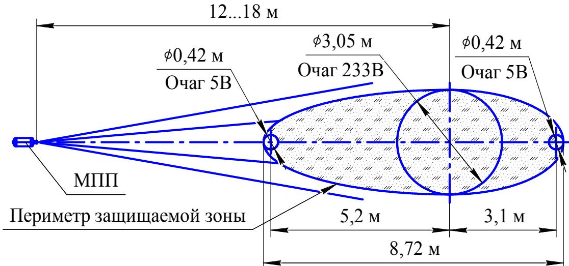
Рисунок 4 – Масштабное изображение защищаемой площади при локальном пожаротушении
