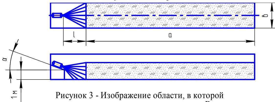
Рисунок 3 - Изображение области, в которой достигается тушение пожара класса В
