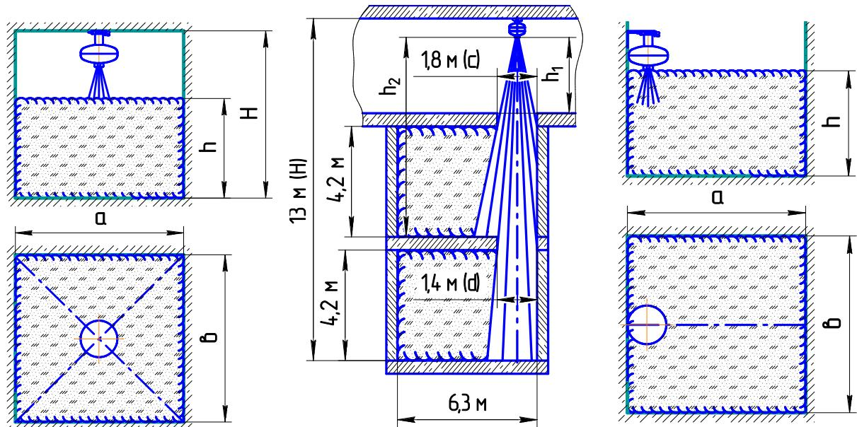
**Параметры тушения МПП потолочного крепления (см. рисунок 5)**
